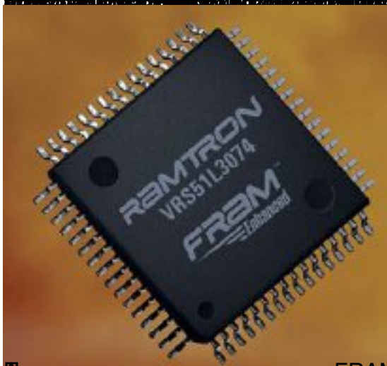
Рис. 2. Фотография микроконтроллера FRAM RAMTRON VRS51L3074 с кристаллом (размер)
