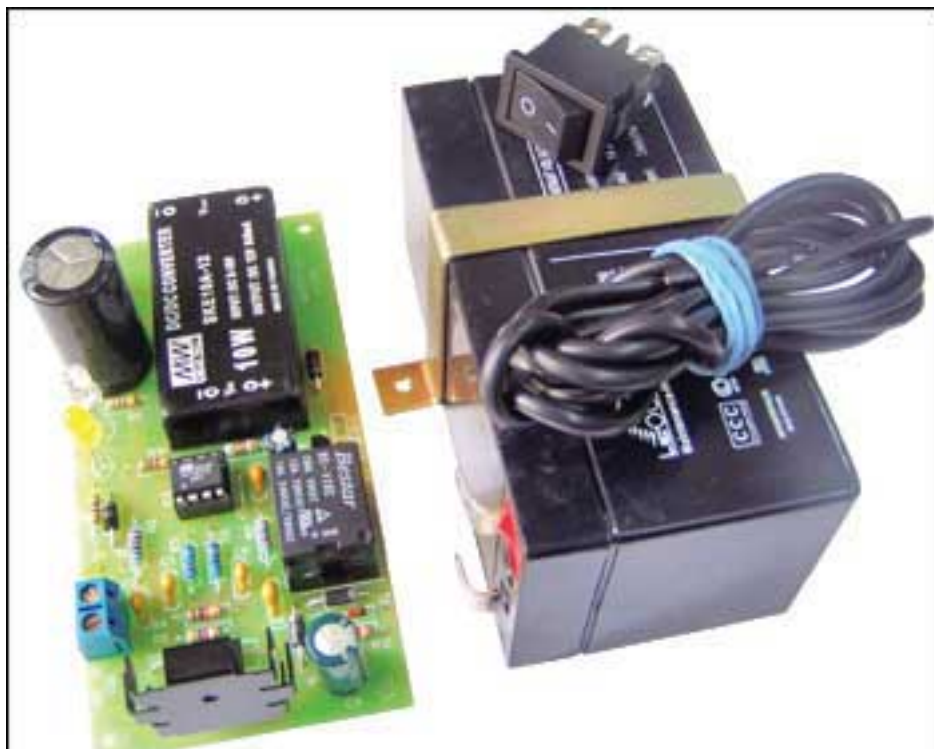
Рис. 10. 0А5 – Вид собранного набора «Источник бесперебойного питания
